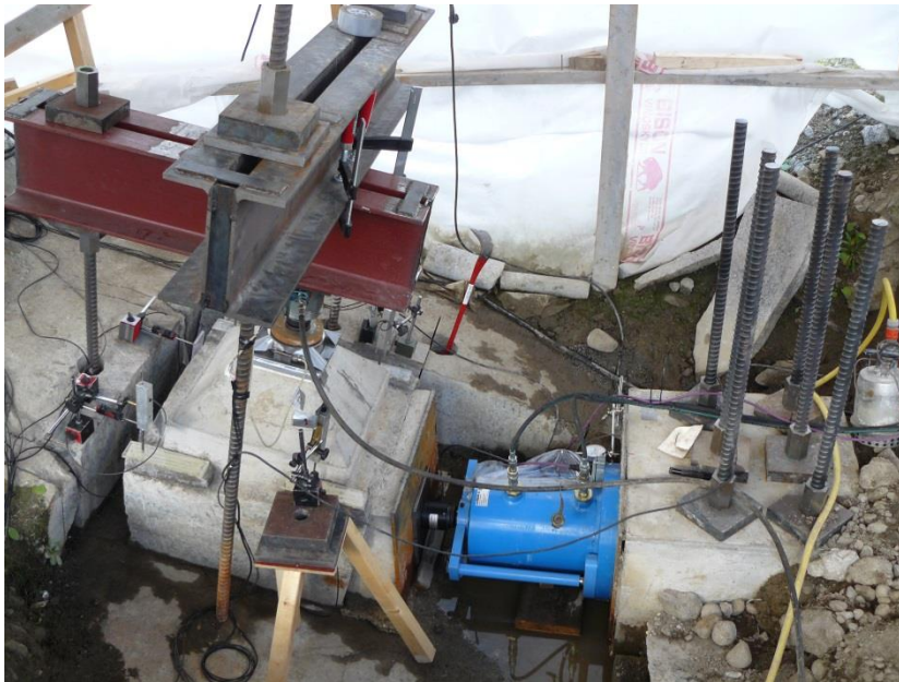
Storskaligt skjuvförsök på bergspricka vid Långbjörns kraftstation (Foto: Fredrik Johansson).
